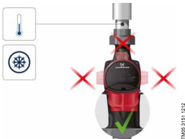
Fig. 4 Kontrolbokspositioner, aircondition- og koldtovandsanlæg
