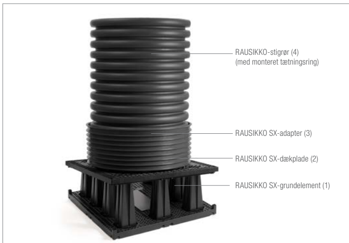
RAUSIKKO-element til et 0,5-lags nedsivnings-/tilbageholdelsessystem ( H = 0,36 \text{ m} )
