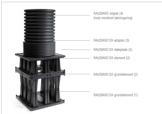
RAUSIKKO-grundelement SX til et 1,5-lags nedsivnings-/magasineringsystem ( H = 1,02 \text{ m} )
