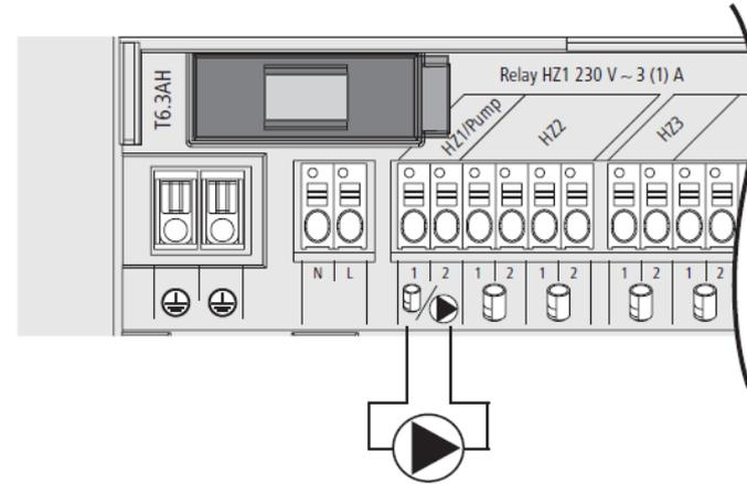
Varmezone 1 (HZ1/pumpe) kan alternativt bruges til at styre en cirkulationspumpe. Cirkulationspumpen tilsluttes på følgende måde:
